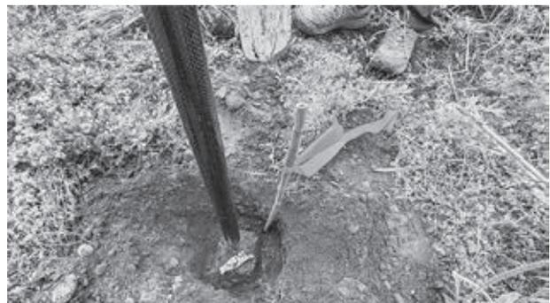
土に埋まったコンクリート境界杭をGNSSでピンポイントに探索
