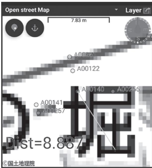
図6 逆打ち機能を利用した「GNSSメジャー」
