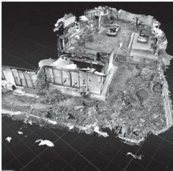
iPad proにはLidarセンサーが搭載されており、空間をスキャンすることができる。さらにデバイスのモーションセンシングハードウェアからの情報とデバイスのカメラから見えるシーンの画像分析を組み合わせたARKit (Apple社のAR開発ツール)によりiPhone pro / iPad proは自己位置推定と環境マッピングを行うことができる。
