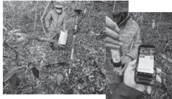
図2 近距離でのRTK測量
