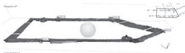
図3. 道路境界での閉合近接SfM写真測量の例
