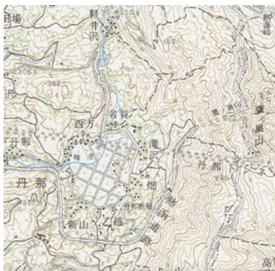
水田の目立つ丸いエリアが丹那盆地で、その下を直線的にくぐるのが東海道本線の新ルートに穿たれた丹那トンネル(昭和9年開通)。北側に並行するのは新幹線の新丹那トンネル。1:50,000 「熱海」昭和51年修正
