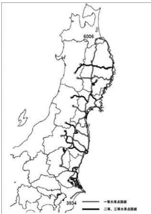
図2 水準点の測量成果公表停止路線図
