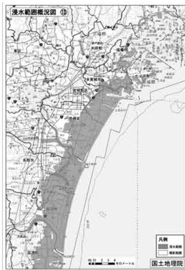
図7 浸水範囲概況図（灰色に塗った部分が浸水範囲）、仙台地域（国土地理院，2011f）
