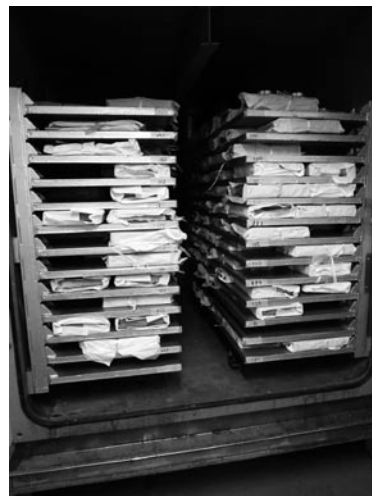
真空凍結乾燥機で凍結簿冊を乾燥
