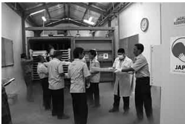
真空凍結乾燥機を使った土地台帳乾燥作業
