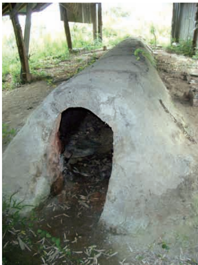
レンガを使わず粘土だけで作った穴窯
