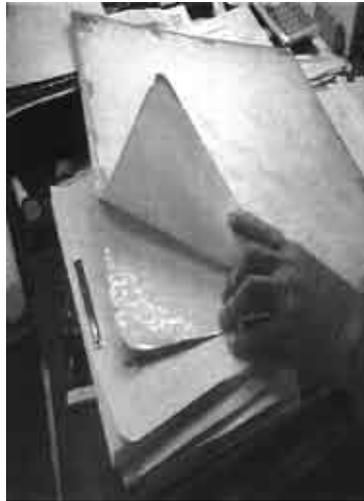
アルミケント紙が分離しアルミが腐蝕して紙面を汚す
