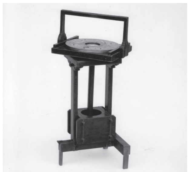
石黒信由創作「強盜式磁石台」磁石盤が自動的に水平になる
